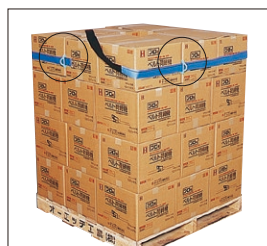
② 助バンで再度ベルトを固定。
