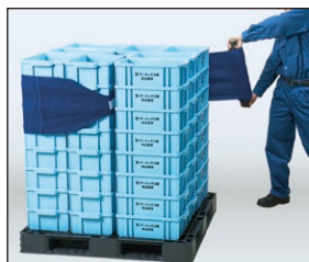
② ベルトを荷物に巻き付けます。
