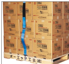
①ベルトを金具に通し、マジックテープで仮止め。
