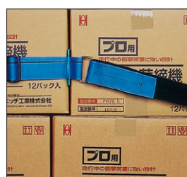
③ ベルトを金具に通し、マジックテープで仮止め。
