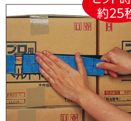
④ マジックテープを強く押さえる。(ワンタッチでOK)
