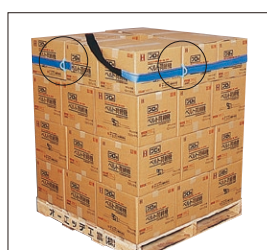
② 助バンで再度ベルトを固定。
