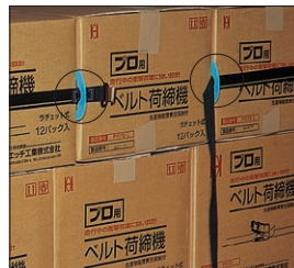
② 助バンで再度ベルトを固定。
