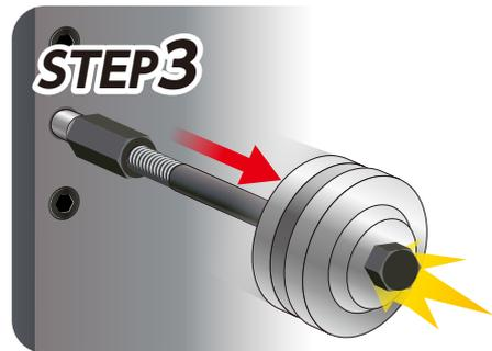
ハンマーをシャフト後部へ打ち付けて部品を引き抜く。
