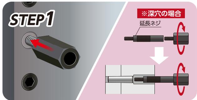
引き抜く部品のネジ穴に、適合するアダプターを取り付ける。※深穴の場合は延長ネジを使用する。
