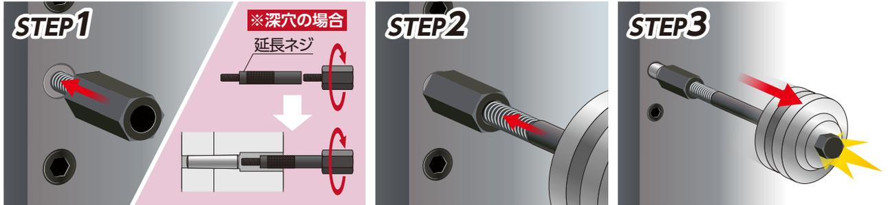
引き抜く部品のネジ穴に、適合するアダプターを
