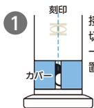
1 接続部カバーの切れ目を、刻印と一直線になる位置へ回します。
