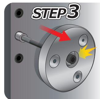
ハンマーをシャフト後部へ打ち付けて部品を引き抜く。
