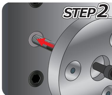
用途に合った長さのキャップボルトにハンマー本体を通し、引き抜きたい部品にボルトを取り付ける。
