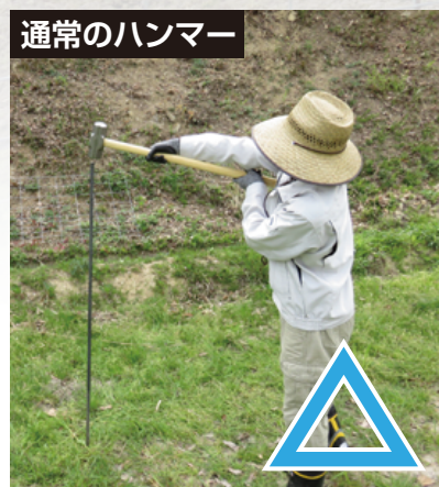
通常のハンマー 打点が高くて打ち込みにくい!
